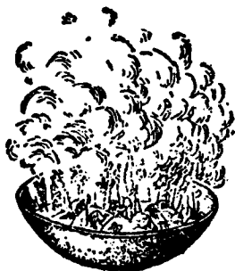
圖 56. 生石灰和水作用 如果把生石灰放在蒸發皿裏（圖 56），逐漸淋入少量的水，不久就看到有大量的熱放出，並且發出嘶嘶的聲音，這時一部分水受熱成蒸氣，同時塊狀的生石灰鬆散開來成為粉末。當我們看到建築工人煮生石灰時，也是這樣情況。這就是由於氧化鈣和水發生了化合反應：
